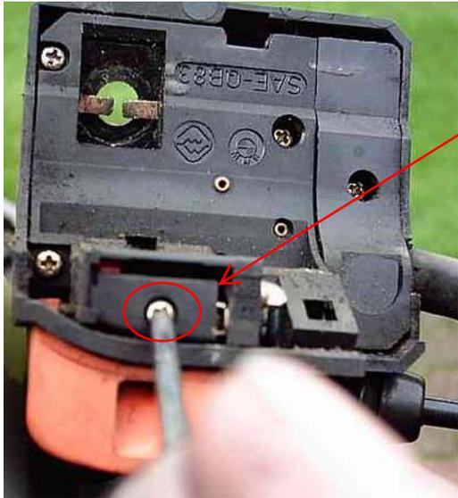
Schraube für Blinkerbetätigung lösen
