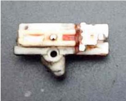
Schiebestück reinigen und Kontaktfläche
