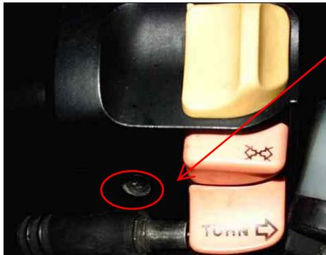
Schraube mit Kreuzschraubendreher lösen
