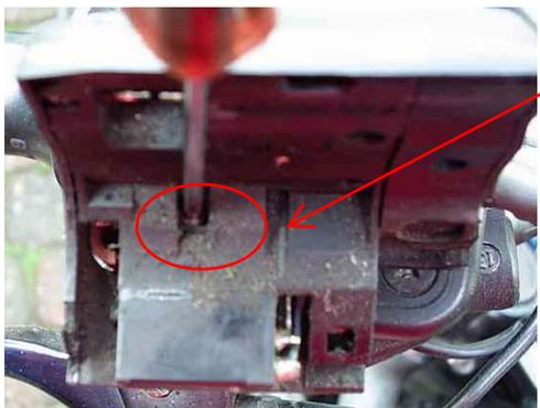
Schraube für Blinkerrückstellung lösen
