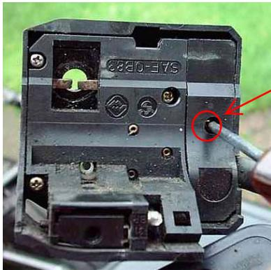
Schraube Kabeleingang lösen
